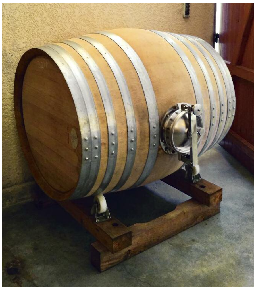
AU CHÂTEAU HAUT-BRETON LARIGAUDIÈRE, TONNEAU POUR LA VINIFICATION INTÉGRALE
