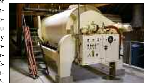
Pour installer le pressoir pneumatique et les cuves attenantes dans les combles, il fallu démonter le toit de la bâtisse posée au milieu des vignes.
